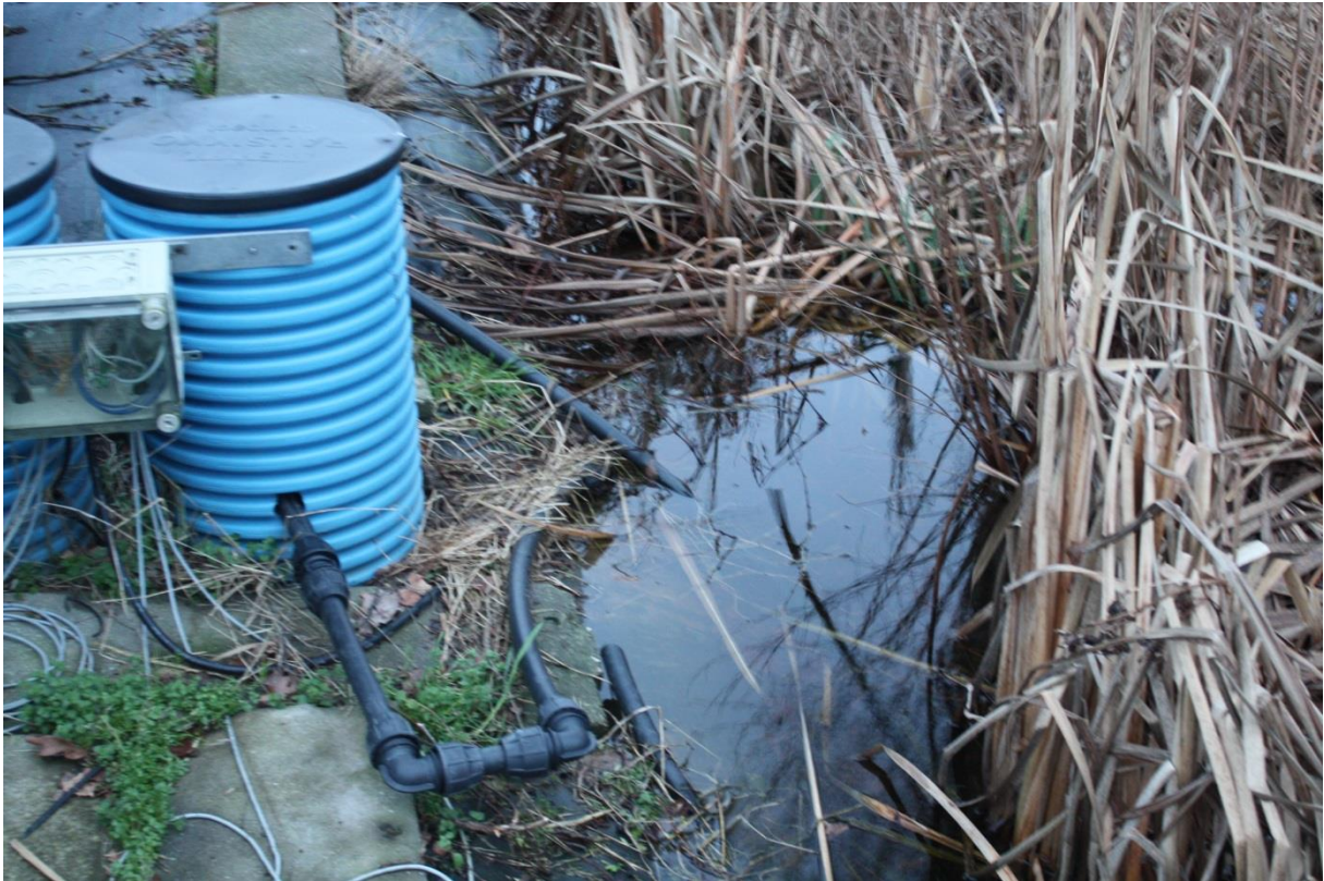
Abbildung 40: Bei einer Einstauhöhe von rd. 26 cm ist der maximale Einstau erreicht.
