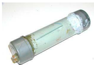
Bolus mit pH-Wertsensor und Funksender
